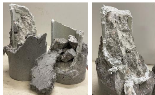
(d) Crushing of HSC core
