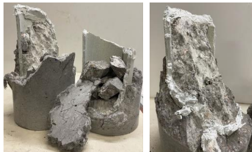
(d) Crushing of HSC core
