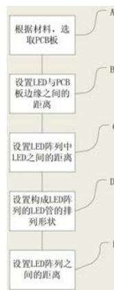
1. 一种LED阵列的排布方法,用于提高PCB板上LED统一照度并促进散热,其特征在于,包括以下步骤:
