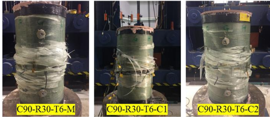
(d) CCFFT specimens (RCL mix ratio = 30%, 6-ply FRP tube)
