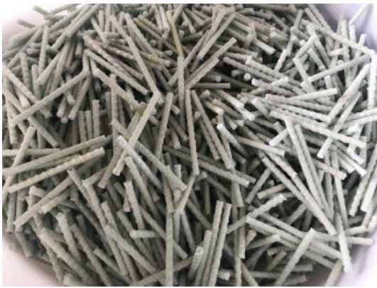
(d) Helically wrapped needles
