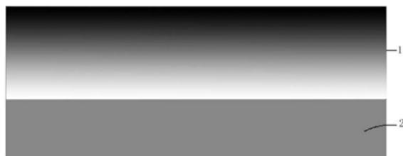
1. 一种非均匀锂离子电池负极片，包括负极集流体以及附着于所述负极集流体表面的负极活性材料层，其特征在于，所述负极活性材料层中含有在锂化和脱锂过程中体积发生变化的合金型负极活性材料，且该电极中负极活性物质在紧邻于集流体表面的区域含量为0%，且自所述负极集流体表面向外，所述合金型负极活性材料在负极活性材料层中的含量越来越高。
