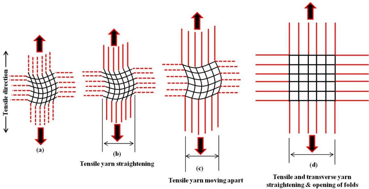
Figure 12. Deformation mechanism: (a) relaxed state; (b) phase-1; (c) phase-2 (d) phase-3.
