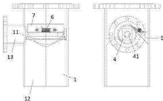
1. 一种内联闭式水力发电机，其特征在于，包括T型喉管(1)、设于所述T型喉管(1)内的垂直涡轮水轮机(2)以及通过所述垂直涡轮水轮机(2)的输出耦合驱动设于所述T型喉管(1)开口(11)处的发电机产生电力的传动轴(3)；所述T型喉管(1)包括第一管道(12)和第二管道(13)；所述T型喉管(1)的所述第一管道(12)的内壁设有固定挡块(5)、活动挡块(7)以及用于根据来流速度调整所述活动挡块(7)开度的扭簧(6)，所述固定挡块(5)为不锈钢材质；所述垂直涡轮水轮机(2)包括蜗轮轴、与所述蜗轮轴固定连接的竖型柱状栅栏式框架(21)以及分别从所述栅栏式框架(21)的多个栅柱(22)向外延伸的多个弯曲叶片(23)，所述蜗轮轴与所述传动轴(3)通过联轴器连接。
