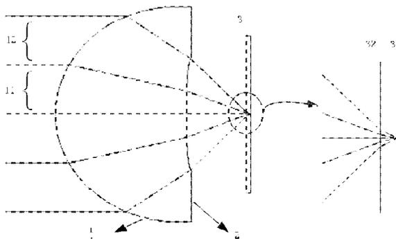
1. 一种用于增强蓝光光盘和中国高清光盘衍射效率的透镜,包括第一透镜面(1)和第二透镜面(2),第一透镜面(1)和第二透镜面(2)将入射光聚焦到聚焦区,其特征在于,所述第一透镜面为自由曲面,所述第二透镜面为非球面。
