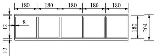
图3 桥面板主要尺寸图(单位: mm)
