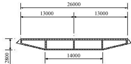
图4 FRP 主梁断面图(单位: mm)
