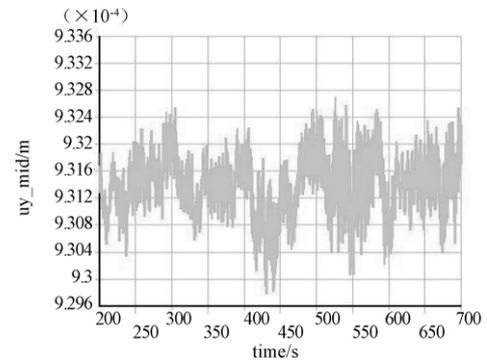
图 11 钢桥主梁跨中节点的竖向位移时程曲线
