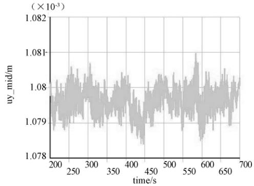
图 10 FRP 桥主梁跨中节点的竖向位移时程曲线
