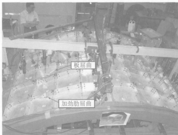
图7 试件A的破坏模式
