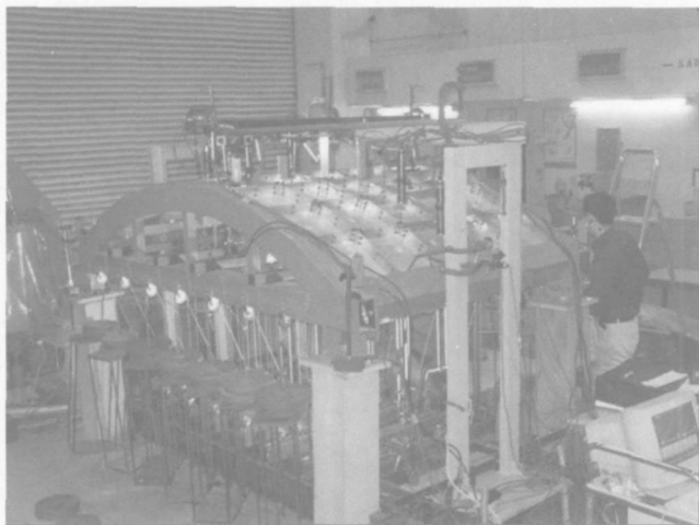
图5 栓接钢底壳的试验装置
