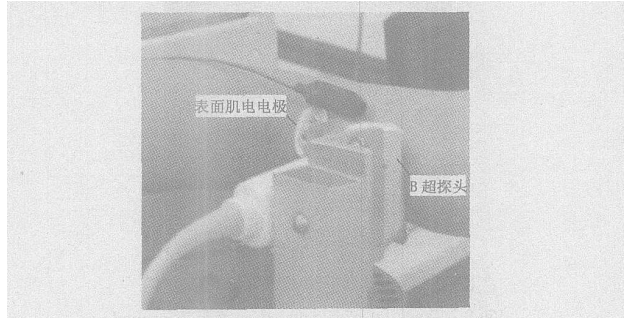
图 2 肌电电极与超声探头位置示意图
