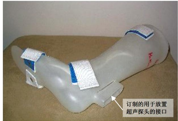
图 2 每位受试者订制专门的 AFO, 超声探头可沿肌腱方向固定其上
