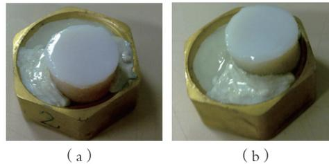
图3 固定在魔术钢胶里面的典型软骨样本
