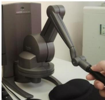
Fig. 3. The PHANTOM<sup>®</sup> Desktop<sup>™</sup> haptic device.
